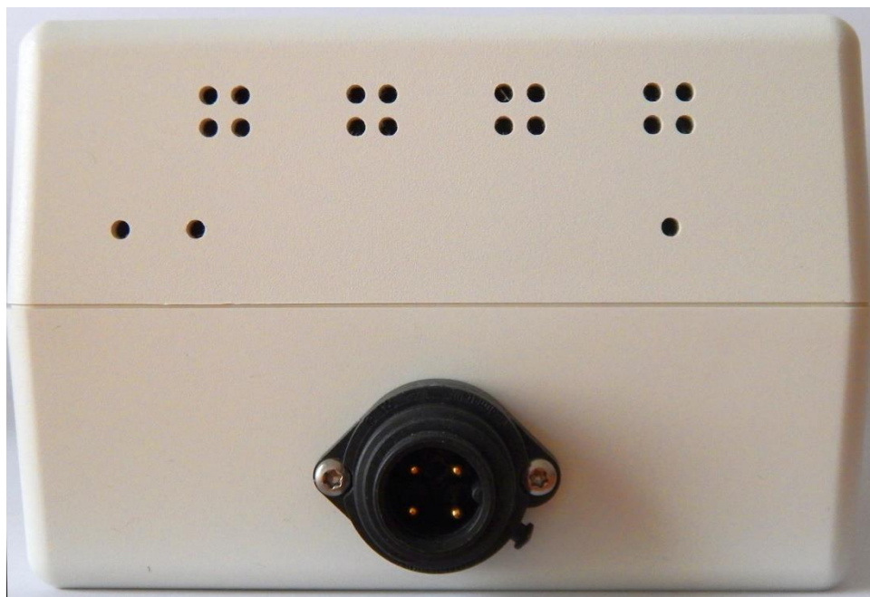
Obr. 6: Spodní pohled na modul s napájecím konektorem.
