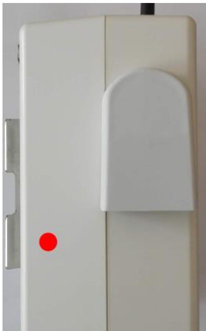
Obr. 7: Znárodnění pozice magnetického jazýčkového kontaktu.
